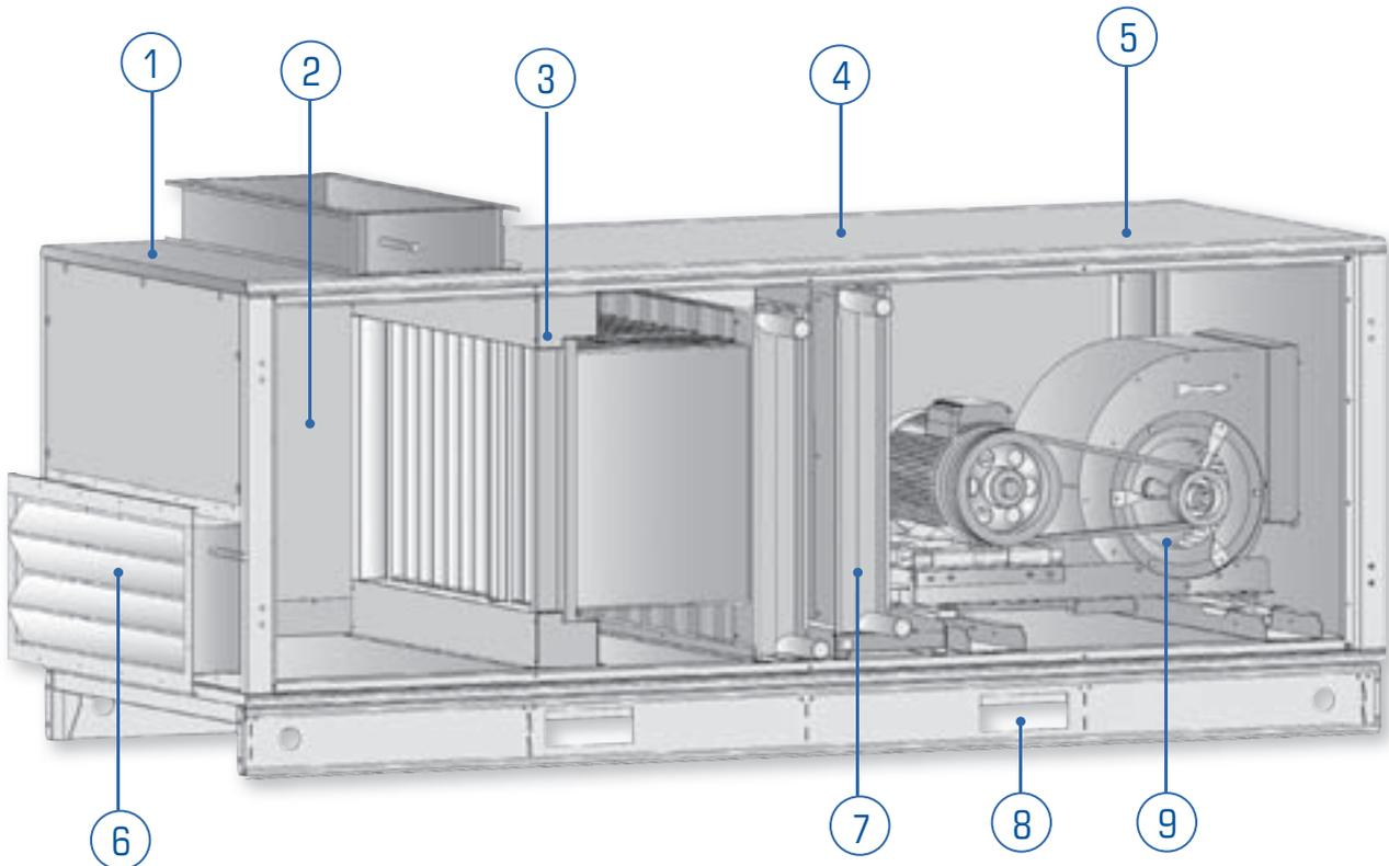
5 Панели с двойными стенками толщиной 50 мм, стандартно с белым эмалевым покрытием наружной поверхности и оцинкованной внутренней поверхностью.
