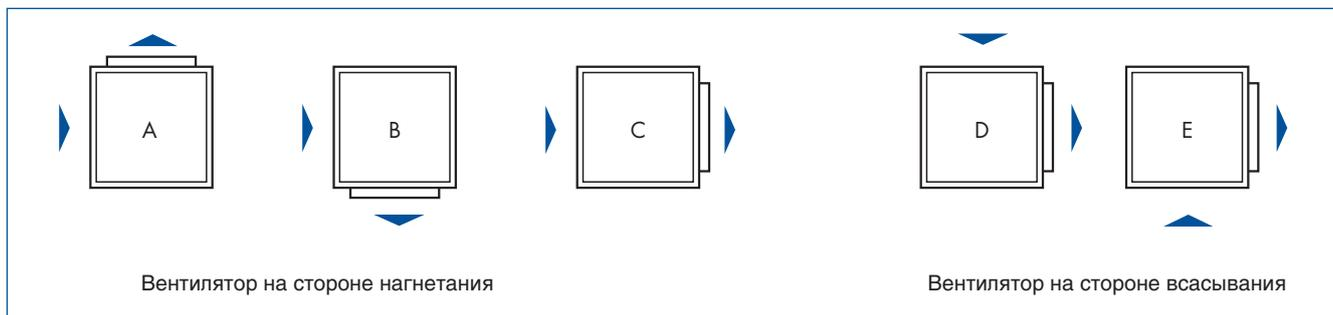
· Расположения А, В, D и E можно получить только с использованием отдельной секции вентилятора 9.
