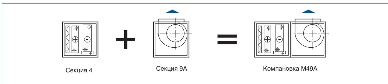
· Агрегаты из двух секций всегда обозначаются двумя цифрами и буквой (напр. М49А).
