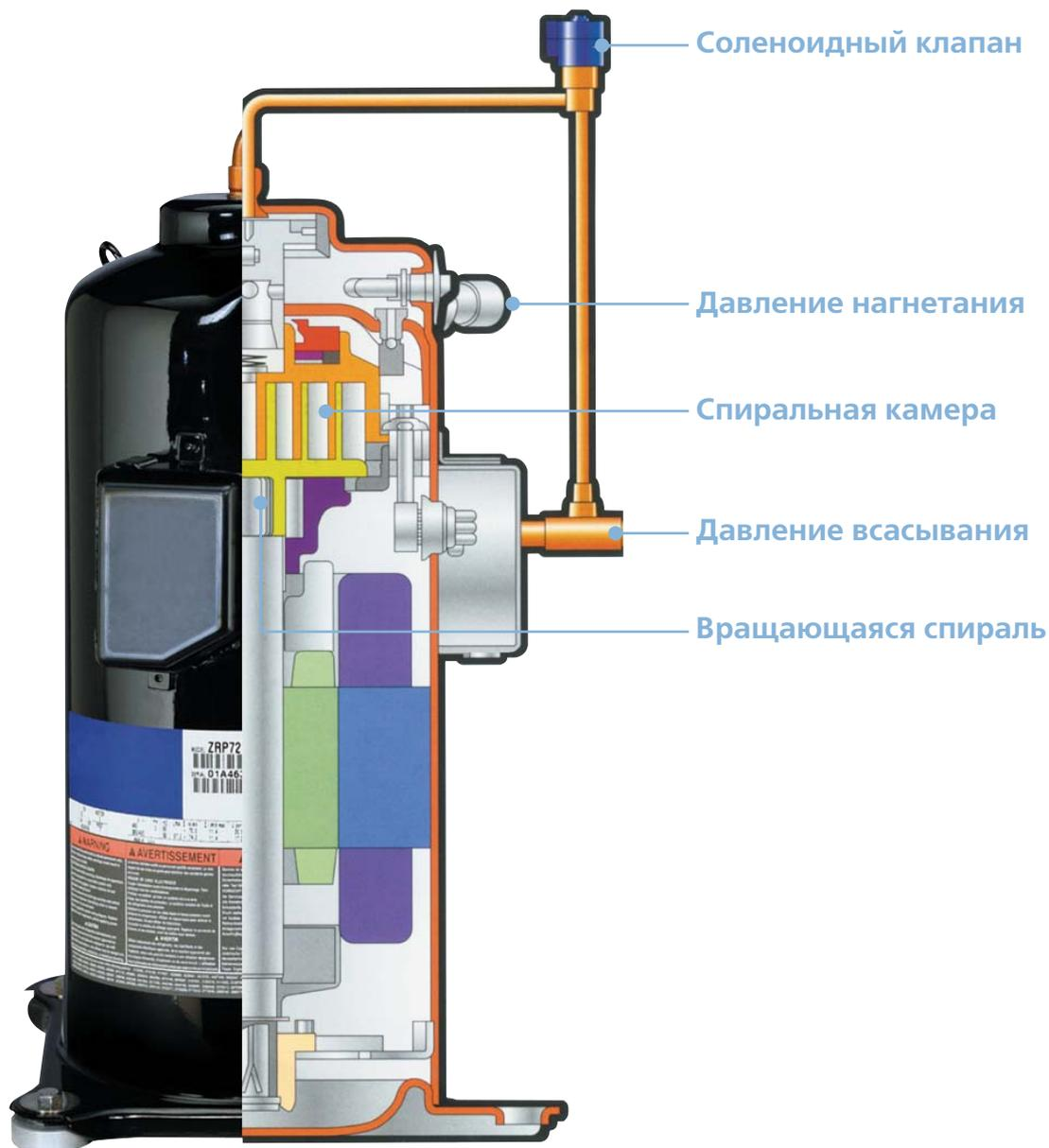
Основной технологии DV-max является компрессор Digital Scroll – спиральный компрессор с полностью цифровым управлением.
