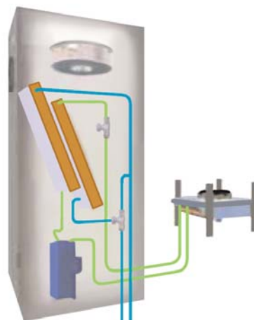
D — Dual-Fluid с воздушным охлаждением конденсатора и с использованием охлажденной воды
