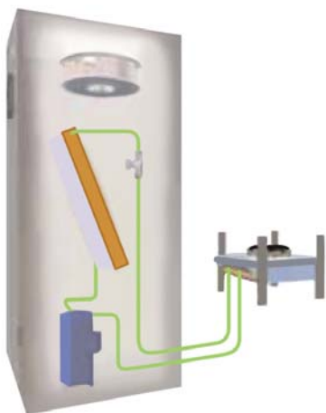
A — с воздушным охлаждением с выносным конденсатором
