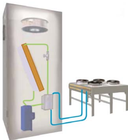
W — с водяным охлаждением конденсатора
